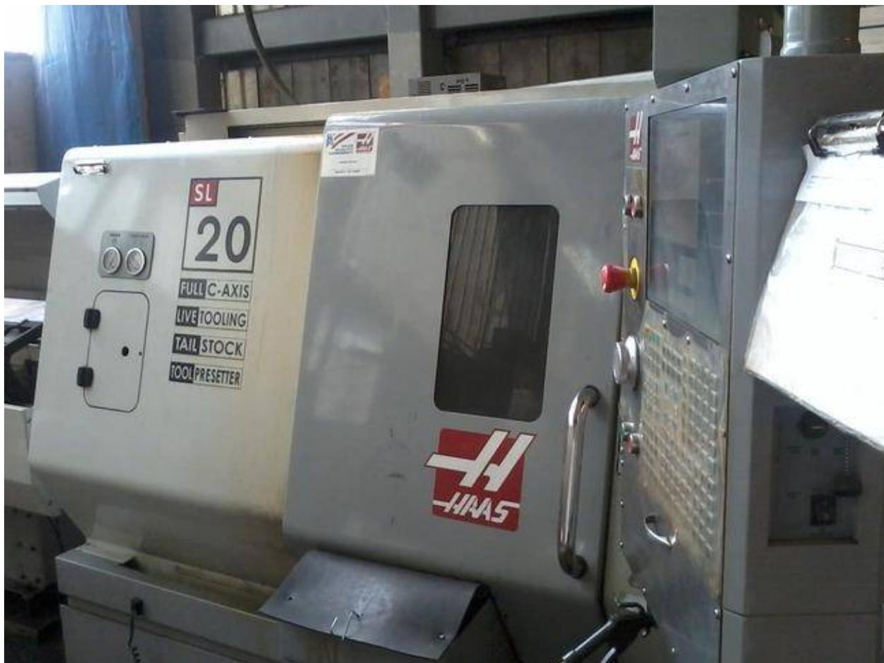
Рисунок 1 – Фото станка с ЧПУ HAAS SL-20 (производство США)
