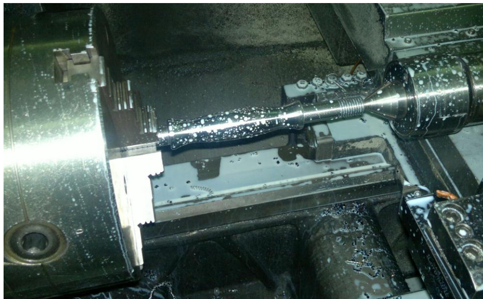
Рис. 3 - Изготовление грифа гантели на станке
